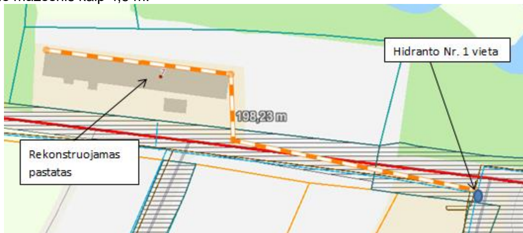
Paveikslas Nr.2. Hidrantų pasiekiamumo schema (hidrantas Nr. 1)
